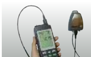
Inspección de transmisores con interface de 4 a 20 mA
