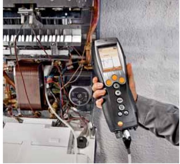
**Accesorios necesarios:** set de conexión de mangueras para mediciones de presión de gas por separado, n° de pedido 0554 1203
