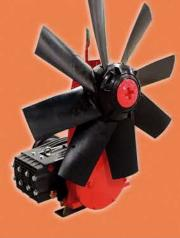
LOS ATOMIZADORES MODELO STAR MONOBLOCK SON MÁQUINAS MUY POTENTES, ROBUSTAS Y FIABLES. CUENTAN CON EL SISTEMA MONOBLOCK CON BOMBA, MULTIPLICADOR Y VENTILADOR MONTADOS EN CONJUNTO EN BAÑO DE ACEITE ESPECIAL PARA ALTAS REVOLUCIONES. A ESTAS MÁQUINAS LES SOBRA AIRE Y LÍQUIDO.
