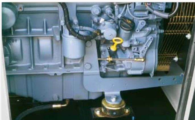
Sistema de refrigeración por aceite integrado
