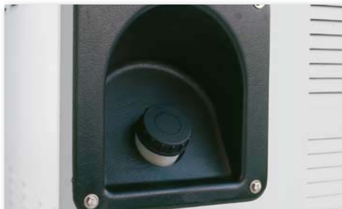
Toma de gasoil externa
