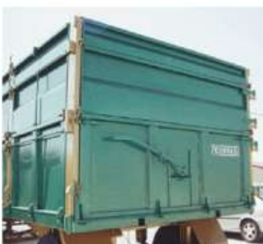
Puerta trasera con apertura 3 posiciones y tablerillo para un lado. Back door with 3-position opening and small board for side. Porte arrière avec ouverture 3 positions et tablette pour côté.
