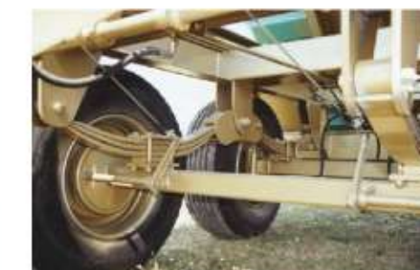
Tandem de ballesta en 4 puntos de apoyo. Spring Tandem on four support points. Tandem de lames-ressort sur quatre points d'appui.
