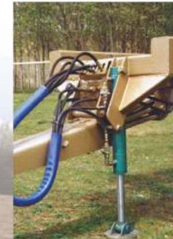
Ballesta amortiguación delantera y apoyo hidráulico directo al tractor. Front damping spring and direct hydraulic support to tractor. Lame-ressort amortissement avant et appui hydraulique direct au tracteur.
