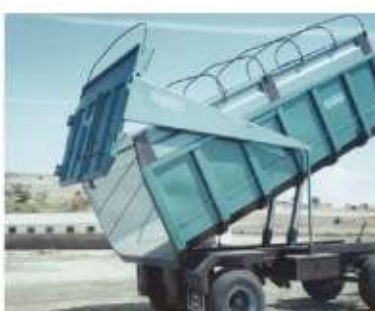
Apertura de portón con brazos. Gate opening with arms. Ouverture du portail à l'aide de bras.
