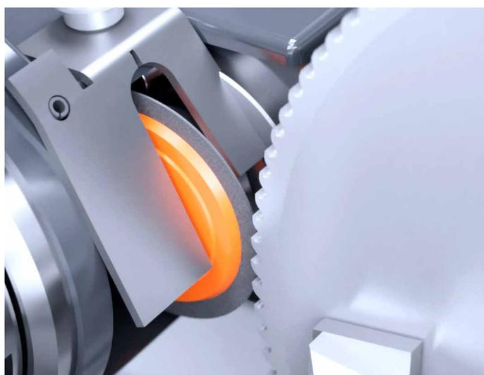
/// MECANIZADO CON ROMPEVIRUTAS EN SIERRAS con muela abrasiva de 50 mm
