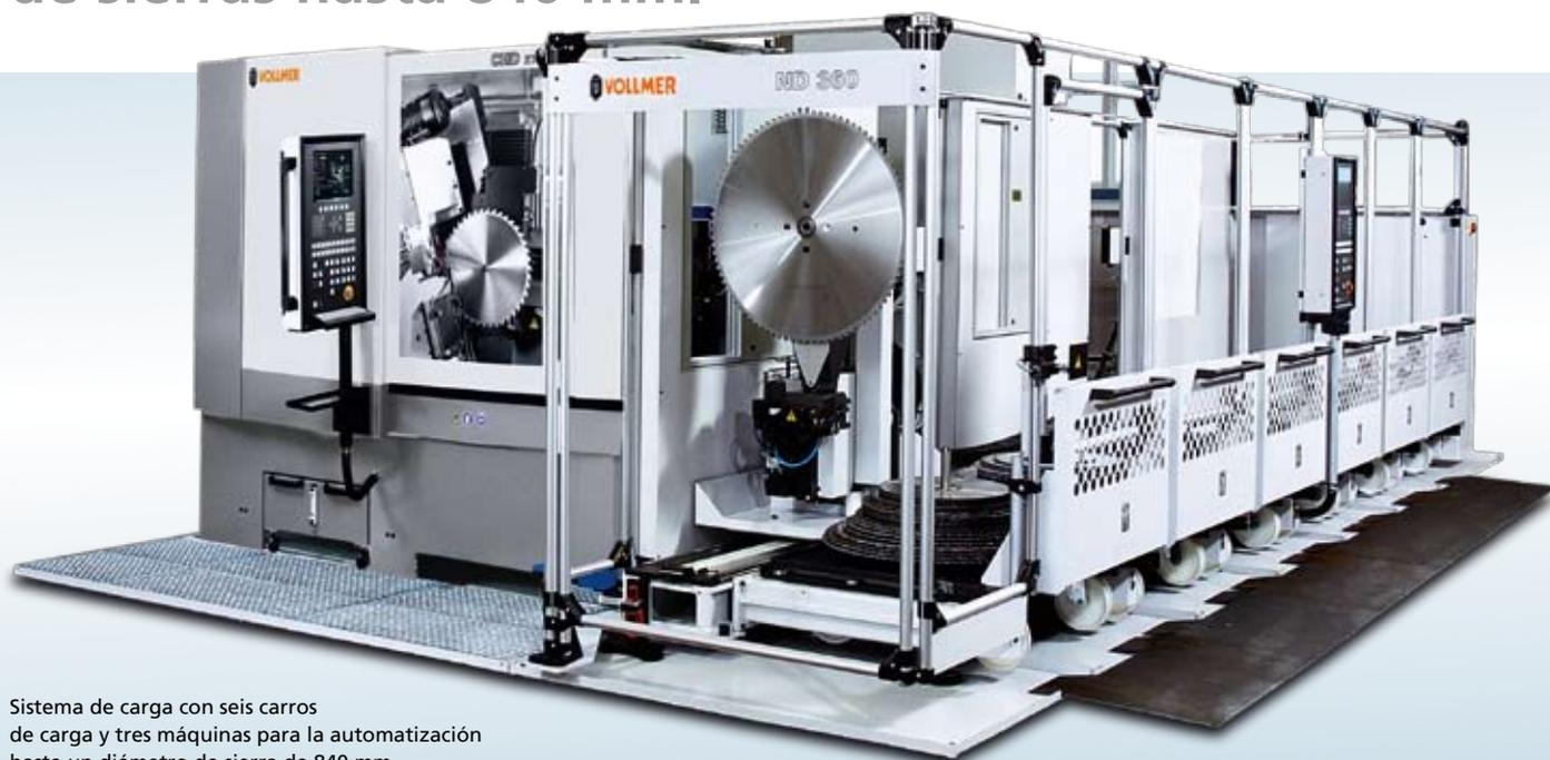
Sistema de carga con seis carros de carga y tres máquinas para la automatización hasta un diámetro de sierra de 840 mm.
