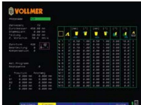
Con el Software VOLLMER para multi-superficies y dientes en grupo se pueden programar diferentes mecanizaciones de superficies, ángulos y oscilaciones en un diente o varios dientes.
