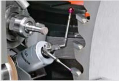
El palpador de medición integrado por defecto recoge todos los parámetros importantes como la anchura de corte, el espesor del disco de sierra, y el ángulo de ataque.
