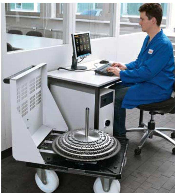
Las pilas de hojas de sierras son preparadas y programadas por medio de una estación de introducción de datos diseñada para uso en entornos de talleres de trabajo.
