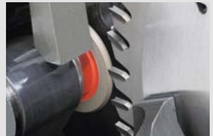
Mecanización de la ranura en V en la cara destalonada.
