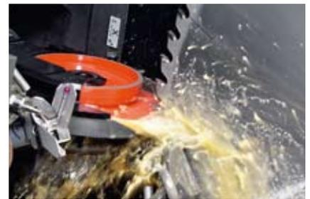
Mecanizado de la superficie de ataque
