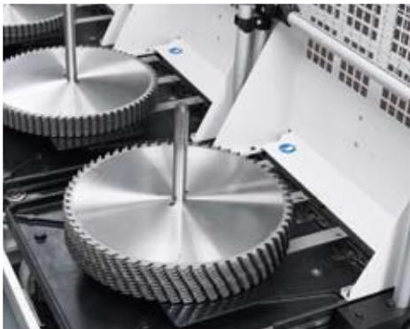
Carro de carga con una pila de sierras en el modo de producción.
