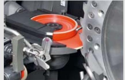
Con el trinquete de avance montado transversalmente, y las porta-sierras correspondientes, los segmentos de trituradores se mecanizan manualmente sin problemas.
