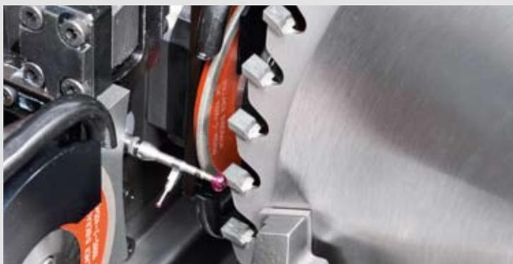
El palpador de medición integrado por defecto recoge todos los parámetros importantes como la anchura de corte, el espesor del disco de sierra, y el ángulo de ataque. También el desgaste de las muelas es controlado y compensado por él. Además ayuda a la medición de nuevos dientes insertados.
