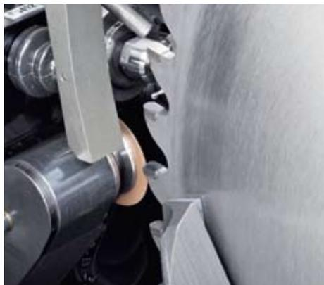
Mecanizado de una ranura rompe-viruta.
