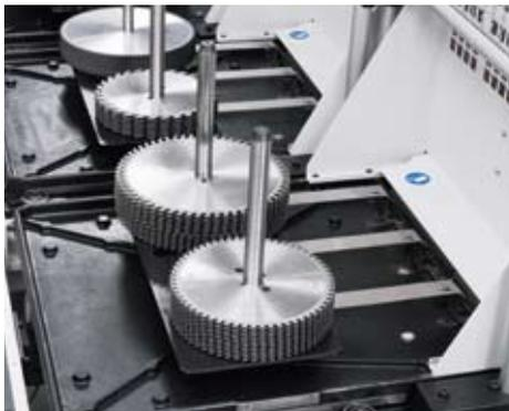
Dos pilas de sierras sobre un carro de carga para aumentar la capacidad de carga.
