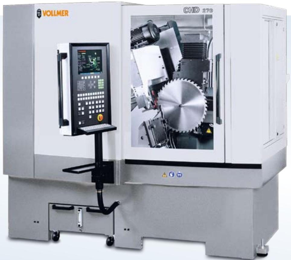
La construcción de la máquina ofrece alta estabilidad tal como óptima operatividad, combinado con poca necesidad de espacio. En la CHD 270 el completo agregado de afilado va montado de manera compacta y robusta en un bloque central (monobloque). Esto garantiza la máxima precisión y marcha suave.
