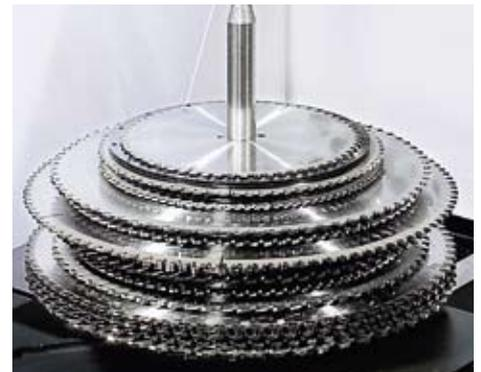
En cada carro de carga pueden ser almacenadas hasta 50 discos de sierras HW con diferentes diámetros y geometrías de diente.
