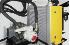
主机润滑机构 Main motor lubrication system
