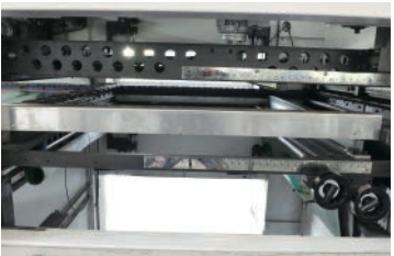
清废部 Stripping unit
