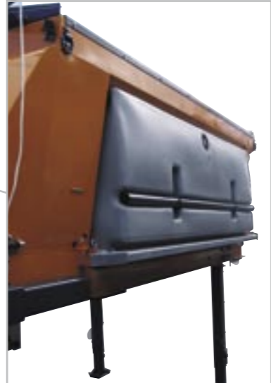
Depósitos de líquido especialmente diseñados para un ritmo uniforme de llenado y vaciado.
