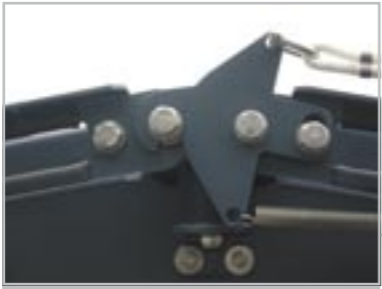
Dispositivo de bloqueo de la cobertura plegable – evita que se abra con viento fuerte.
