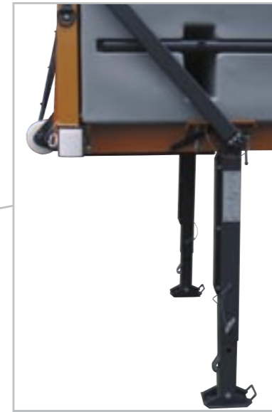
“Rodillo fijo” – sistema de carga rápida hasta 14 toneladas.
