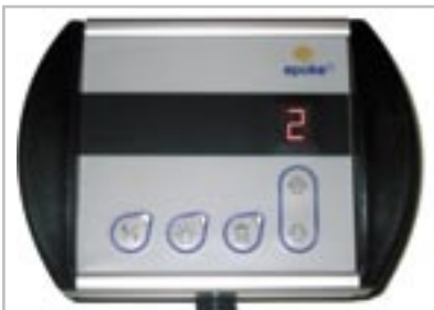
El control remoto EpoSet está instalado en la cabina para el control de arranque y parada del esparcidor, anchura de reparto, con testigos de trabajo y naranja de alarma.
