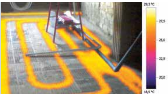
Reconocimiento de tuberías cubiertas con TwinPix también en imagen real
