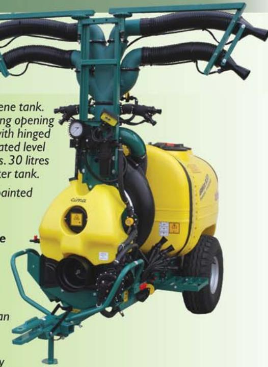
★ La pompe centrifuge fabrication C.I.M.A. (sans membranes et clapets) produite en matériel anti-corrosion est fiable et sans entretien. Sa courroie de transmission 3V est équipée d'un tendeur automatique.
