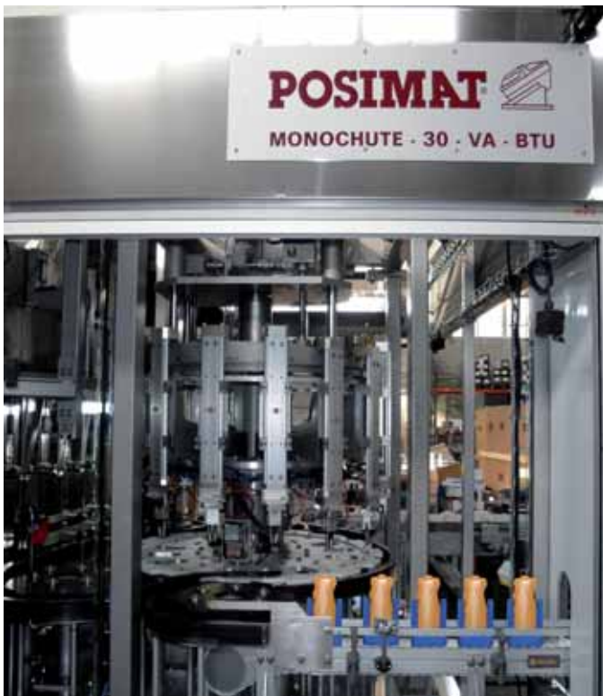
BTU integrada en posicionador Monochute (pucks de etiquetado)
