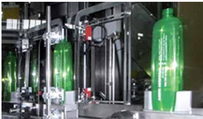
Detalle del transportador de salida (pucks de etiquetado)
