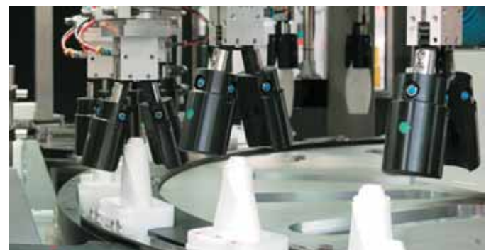
Sistema neumático de pinzas (pucks de cavidad ajustada)
