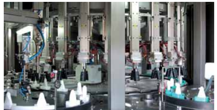
Entrada y salida de botellas en BTU (pucks de cavidad ajustada)
