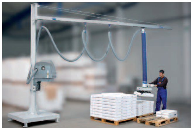
Pluma de columna con perfil de rodadura de aluminio, capacidad de carga 65 kg, longitud de brazo 5 m, con placa base
