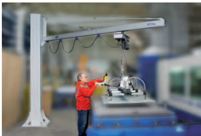
Pluma de columna con perfil de rodadura de aluminio, capacidad de carga 325 kg, longitud de brazo 4 m
