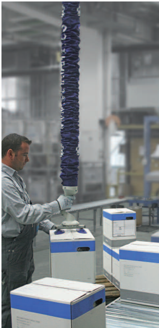
JumboFlex, capacidad de carga de 35 kg, con ventosa doble para la manipulación de cajas de cartón en el sector de mensajería
