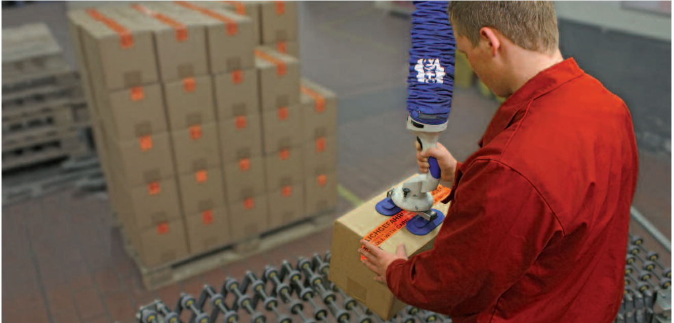
JumboFlex, capacidad de carga de 35 kg, con ventosa doble, para la manipulación de cajas de cartón
