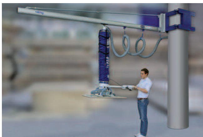
Columna de hormigón fijada, capacidad de carga 140 kg, longitud de brazo 4,5 m
