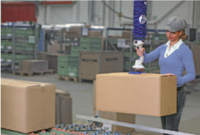
JumboFlex, capacidad de carga de 35 kg, con ventosa doble, para la manipulación de cajas de cartón
