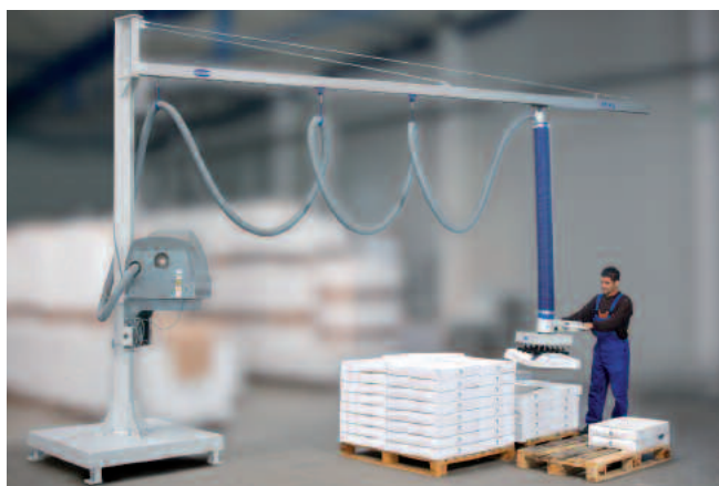
Pluma giratoria de columna con riel de aluminio, capacidad de carga 65 kg, longitud de brazo 5 m incl. placa base
