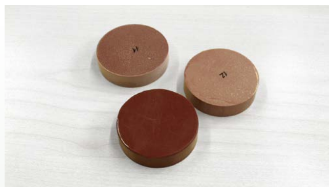
Alteraciones de color de muestras de resina de colado en función de las sustancias de descomposición en \text{SF}_6
