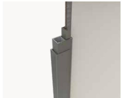
(ES) La barra de carga inferior de gran capacidad permite optimizar el tensado vertical y ofrecer mayor resistencia. Conseguimos una compensación óptima del tejido mediante el uso de contrapesos. Para compensar el posible desnivel de la superficie, integramos una goma de sellado de 15 mm de altura, con la que también impedimos el paso del agua.
