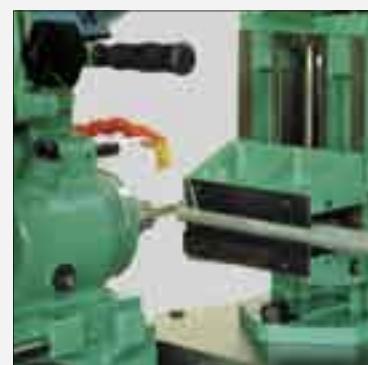
Fresa de la cabeza del tubo. Maquina predispuesta para trabajar a 90° respecto a la pieza.
