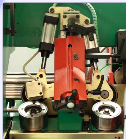
Gruppo di alimentazione: è messo in movimento da un motore brushless per un controllo ottimale della velocità e dell'accelerazione della barra
