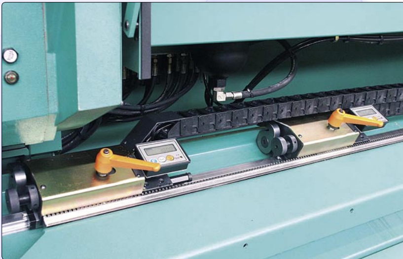
Fermo barra a regolazione veloce con lettura su banda magnetica.
