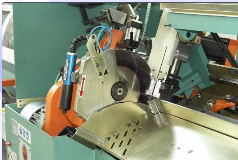
Unità di taglio: velocità di rotazione della lama programmabile da 30 a 300 giri/m, lame montabili da 140mm a 370mm. Unità di scarico: rapida e silenziosa. La MCL 120 può essere collegata a unità di sbavatura, di impilatura e di lavaggio.
