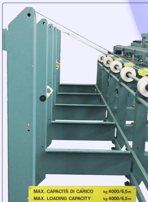
Caricatore a cinghie da 4.000 Kg con pretensionamento cinghie
