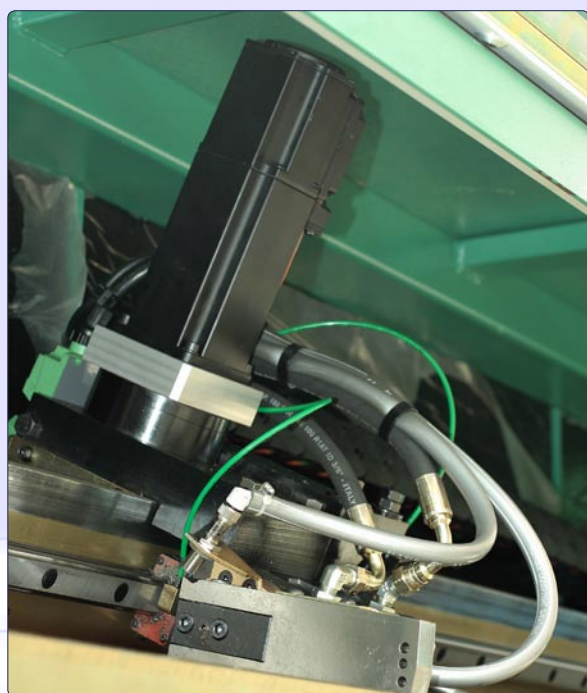
Fermobarra motorizzato: azionato da un motore elettrico brushless che ne consente un movimento rapido e preciso
