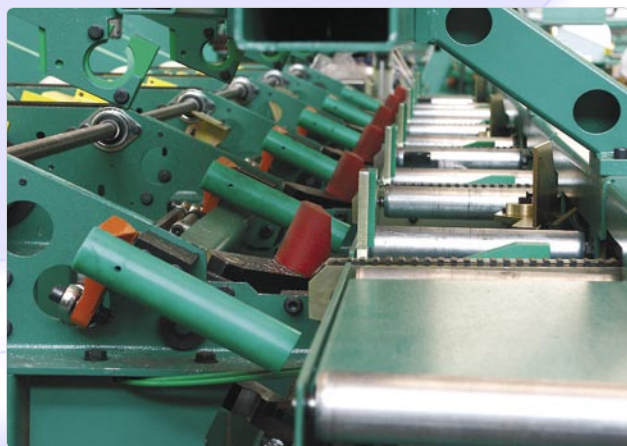
Sistema di carico, allineamento e rotazione automatica dei profili.
