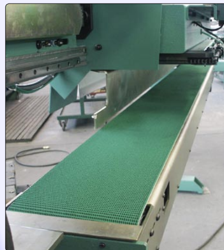
Nastro motorizzato per scarico in più zone programmate
