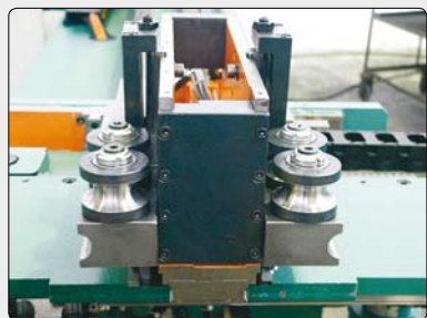
Supporto slittone ad asse controllato destro-sinistro.
