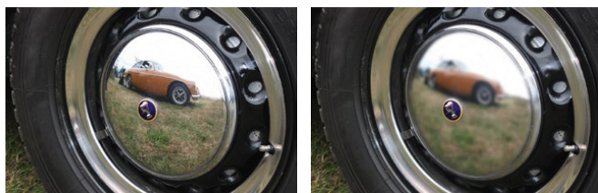
Ejemplo de una superficie recubierta y pulida con y sin neblina reflejada.
