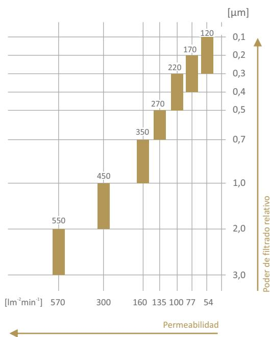
Condiciones:  $\Delta p = 100 \text{kPa}$  (1bar), Medio: agua a 20°C.
