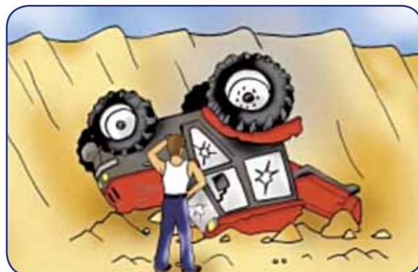
Figura 3. Para evitar el aplastamiento en caso de vuelco, el tractor debe llevar una estructura de protección homologada.
