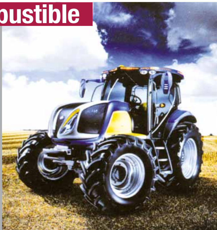
▲ New Holland NH2, tractor alimentado por hidrógeno.
