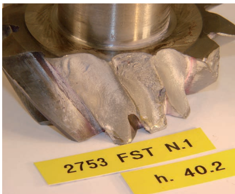
Figura 3 - Rotura de la base de los dientes del piñón NO ORIGINAL
