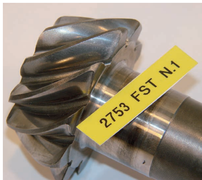
Figura 4 - Desgaste de los dientes del piñón ORIGINAL Carraro a final del test
