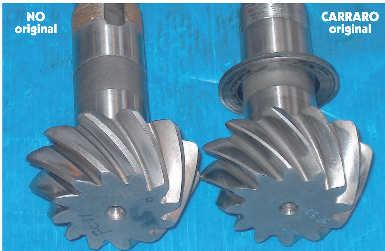
Figura 2 - Test comparativo entre un par cónico original y una muestra disponible en el mercado.
