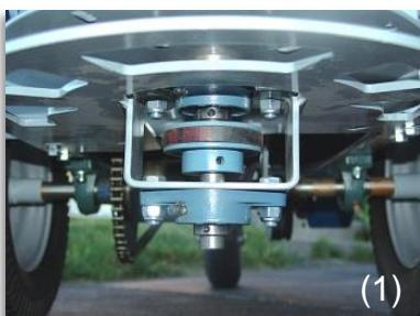
(1) Su sistema de difusión de doble disco a rotación inversa asegura un esparcido uniforme, incluso con materiales pesados tales como arena o ciertos productos para esparcido
