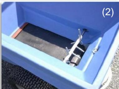
(2) En la parte inferior de la tova, una cinta transportadora lleva el producto hasta un agitador triturador que asegura el desmenuzado del material. A continuación, el producto es proyectado a través de una escotilla de alimentación ajustable y cae sobre el disco giratorio que lo expande uniformemente sobre el suelo (este sistema asegura un esparcido uniforme sobre una anchura de hasta 4,25 metros)
