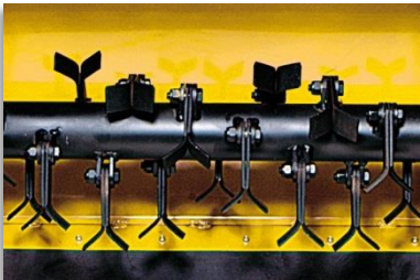
Rotores de 32, 40 y 48 martillos flotantes “Y”
