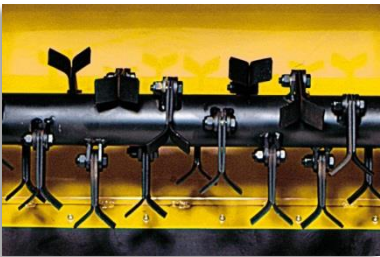
Rotor de 52 martillos flotantes “Y”
