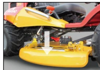
Ajuste de la altura de corte deseada
