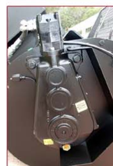
▲ Transmisión por reductor Gearbox system
