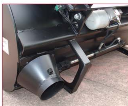
▲ Sistema de vaciado inferior Bottom discharging system
