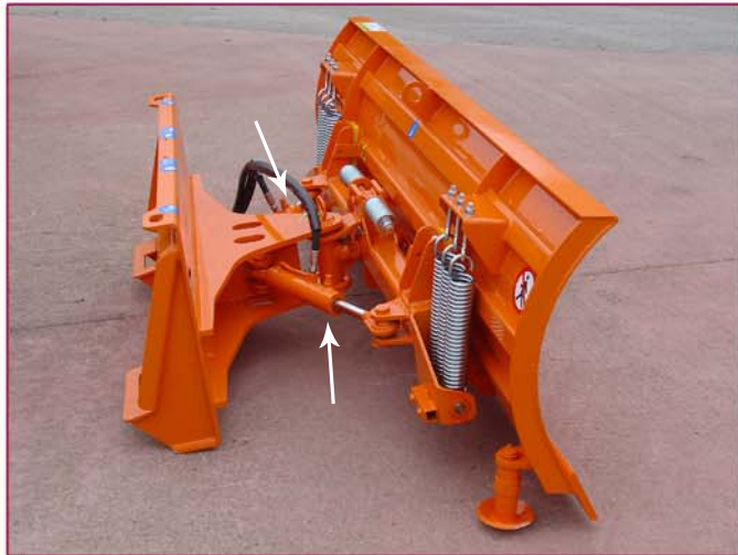
▲ Angulación horizontal hidráulica Hydraulic horizontal angulation
