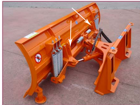
▲ Barras de fijación para trabajar como dozer Fixing bars to work as a dozer
