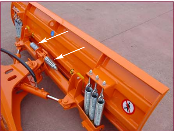
▲ Oscilación lateral con autonivelación por muelles Lateral oscillation with self levelling by springs
