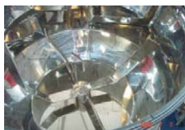
Detalle interior mezclador WSQB y aspas mezcladoras
