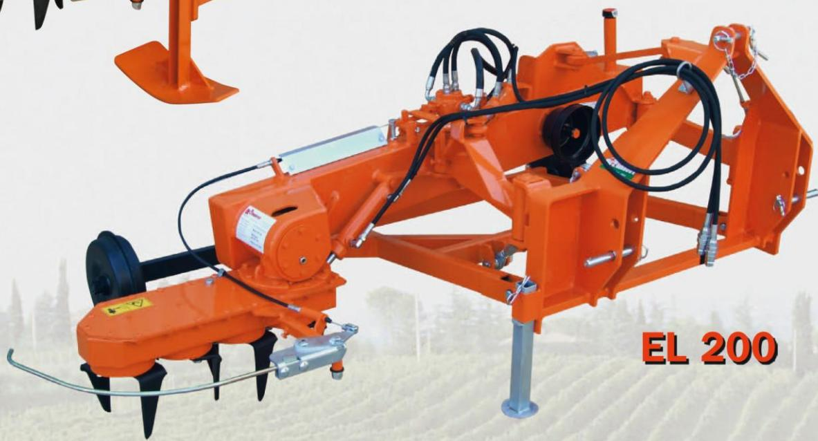
**Coltivatrice interceppi a comando idraulico a denti rotanti posti su quattro assi verticali. E' particolarmente adatta per lavorare in filari con ceppi vicinissimi (50 cm.) in cui si richieda una estirpazione delle erbe infestanti con una minima profondità di lavoro. E' un'ottima livellatrice del terreno e non crea fossi durante lo spostamento.**
