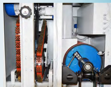
Grupo D con tambor grande con cinta abrasiva + Grupo C con cepillos Conjunto D rolo com cinta de lixa abrasiva + Conjunto C duas unidades de escovas
