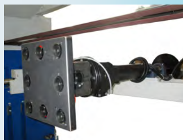
Sistema de amarre de la pieza Posicionador para fixação da peça
