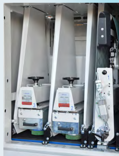
Grupos RTT - 1 Unidad de cinta abrasiva + 2 Unidades con cepillos Conjunto RTT - 1 unidade lixa + 2 unidades escovas top
