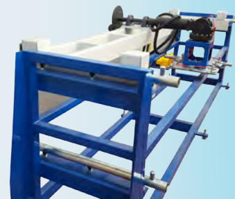
Sistema de amarre de la pieza Posicionador para fixação da peça
