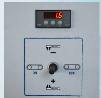
Visualización digital del espesor Display digital da espessura
