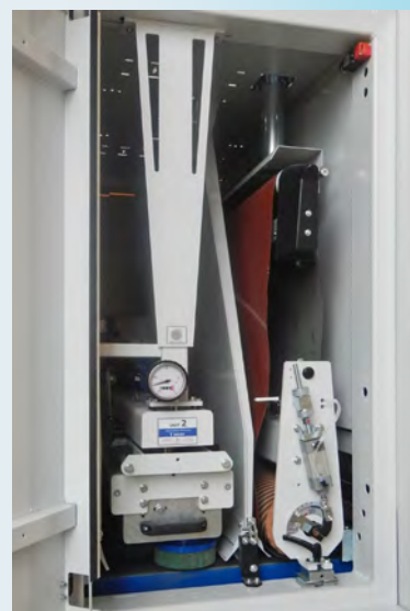
Grupo RT Unidad de cinta abrasiva + Unidad con cepillos Top Conjunto RT Unidade lixa + unidade escova
