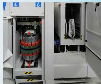
1 Grupo R de cinta abrasiva + 1 Grupo CS con cepillos de scotch brite 1 Unidade R lixa + 1 unidade CS escova de scotch brite
