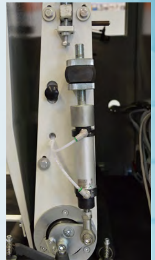
Sistema neumático para el tensionamiento de la lija Sistema pneumático dsa tensão da correia
