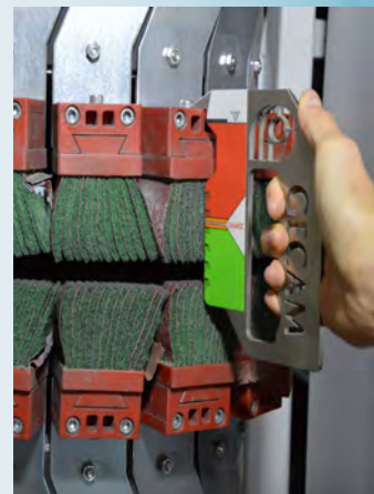
Medición del desgaste de los cepillos Medição do consumo da escova
