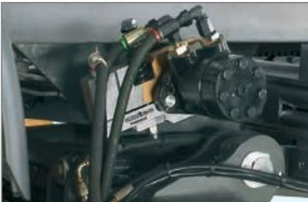
Motor hidráulico y freno (patentado)
