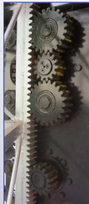
Piñones del grupo motriz y paracaídas Drive unit and overspeed brake pinions
