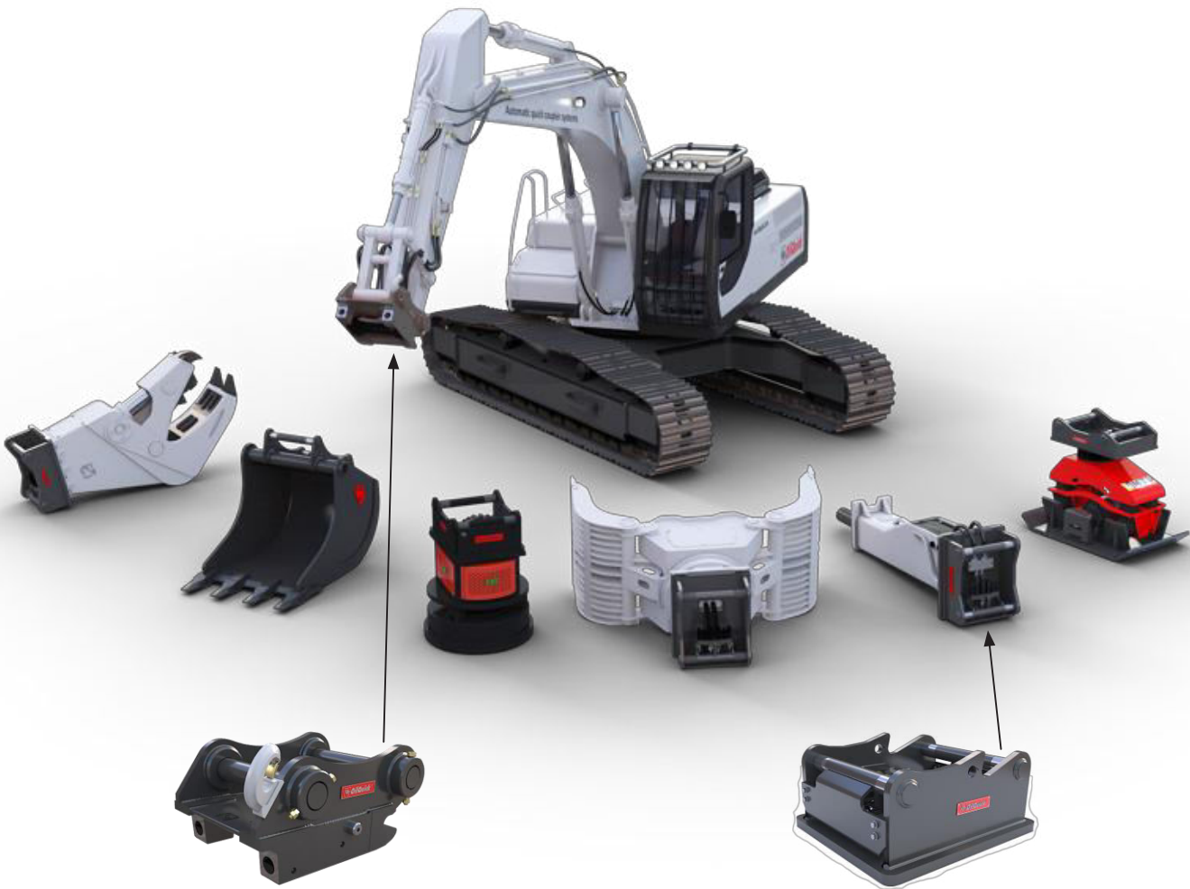
Sistema de acoplamiento con acoplamientos eléctricos e hidráulicos
