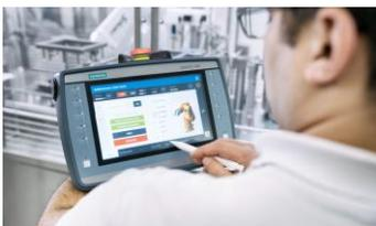
Con uniVAL pi, **Stäubli está lanzando ahora una solución de software que permitirá la programación de robots en el futuro a través del PLC, utilizando Plug & Play en Siemens TIA Portal.** Gracias a esta interfaz de comunicación opcional, los usuarios pueden programar robots Stäubli sin necesidad de conocimientos específicos de lenguaje de alto nivel del fabricante en su entorno familiar, de manera segura, rápida y eficiente.
