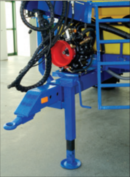
Mediante el Sistema Tracmatic nuestro pulverizador seguirá, en las curvas, la rodada del tractor a fin de no dañar el cultivo.
