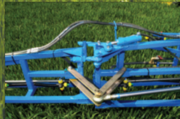
Sistema de bloqueaje que asegura una estabilidad permanente en las barras (5 TR y 7 TR) incluso en suelos irregulares permitiendo una pulverización precisa y uniforme en todo el campo.
