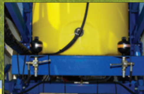
Amortiguación en el chasis del pulverizador modelo TAURUS.
