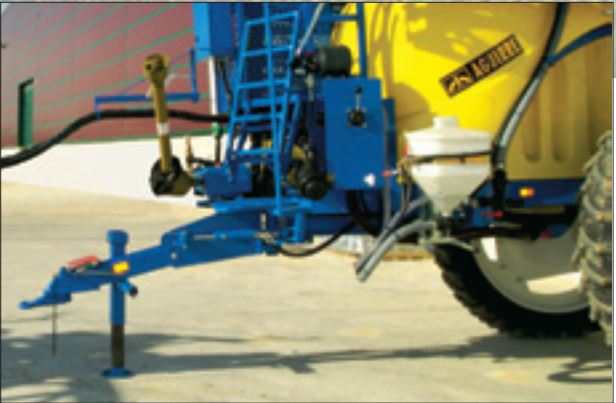
Mediante el Sistema Tracmatic nuestro pulverizador seguirá, en las curvas, la rodada del tractor a fin de no dañar el cultivo.
