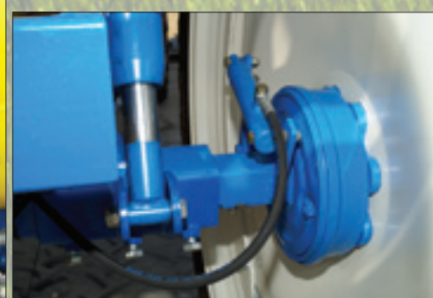
Amortiguación en el chasis del pulverizador modelo NORMA. Este tipo de suspensión otorga gran estabilidad a todo el conjunto chasis-barra pulverizadora.
