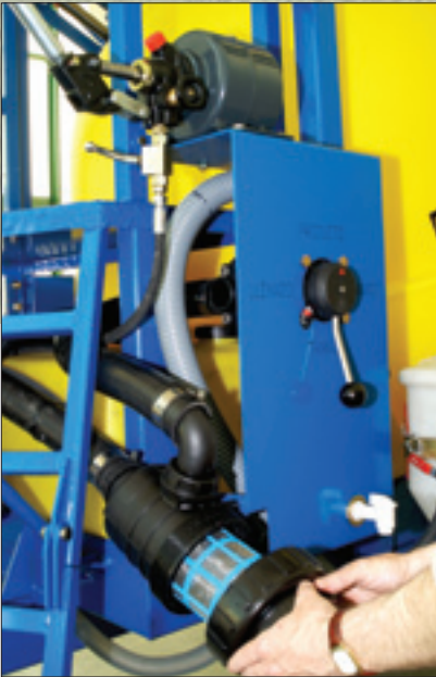
De fácil acceso a todos los comandos del pulverizador: filtros, llaves de accionamiento de las diferentes funciones, freno de estacionamiento, etc...
