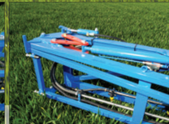
Sistema de bloqueaje que asegura una estabilidad permanente en las barras (5 TR y 7 TR) incluso en suelos irregulares permitiendo una pulverización precisa y uniforme en todo el campo.
