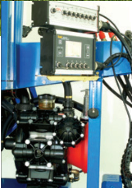
Bomba de membranas de 250 lts/min. que permite tratamientos de altas dosis de litros por hectárea. Todos los mandos del pulverizador – circuito de agua e hidráulico - van en la cabina. El pulverizador dispone de un soporte para su guardado cuando la máquina no trabaja. Todas las conexiones están protegidas a fin de alargar la vida útil de los componentes.
