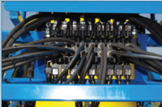
Por medio de un distribuidor eléctrico podemos actuar sobre todas las funciones mecánicas de nuestra barra.
