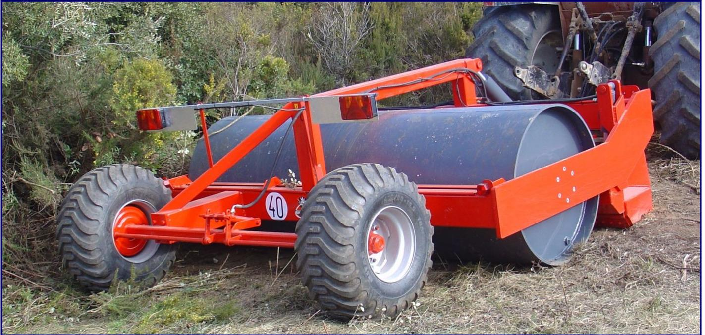
Máquina diseñada para trabajos de reconstrucción de caminos, pistas rurales, forestales y nivelaciones de tierras. En la parte delantera lleva una cuchilla inclinable reforzada para dar las pendientes y badenes para conducir el agua a las cunetas. En el tiro, incorpora un cilindro que nos permite ajustar el trabajo a realizar.
