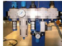
Detalle del sistema de filtrado y control neumático
