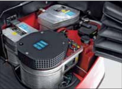
Motores de traslación / dirección / elevación y depósito hidráulico con protección antideflagrante
