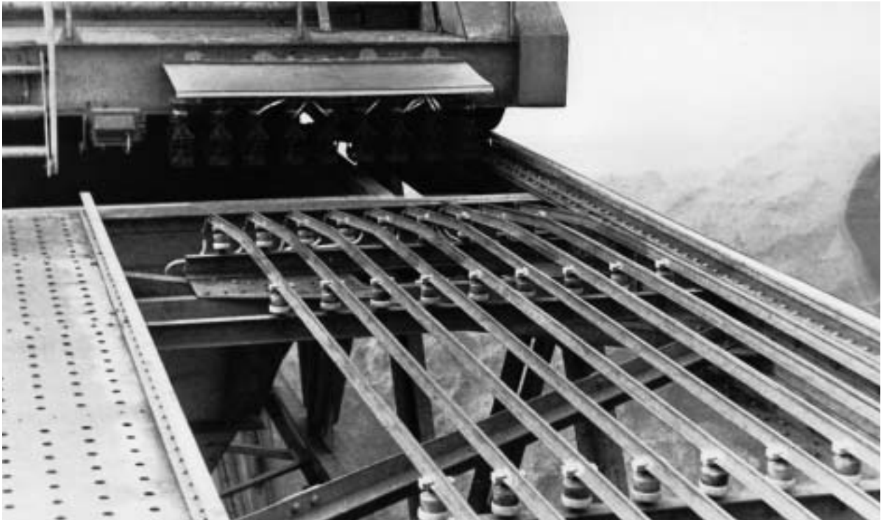
Puente grúa – disposición de una transferencia de conductores
