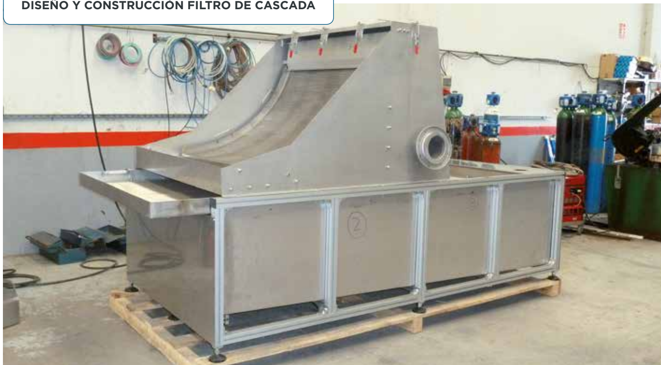
DISEÑO Y CONSTRUCCIÓN FILTRO DE CASCADA
