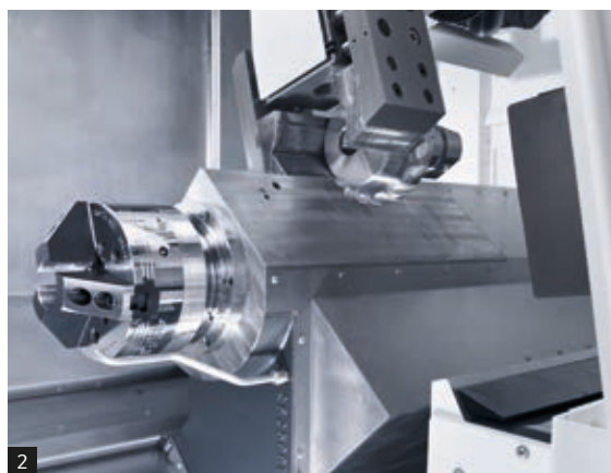
1+2: Toma de una pieza terminada del contrahusillo para ponerla en la cinta transportadora
