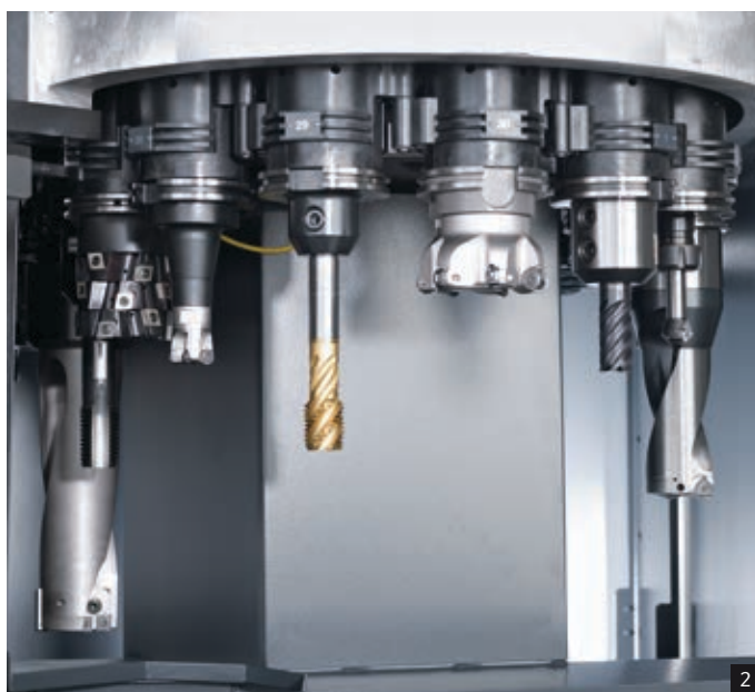
1: Mesa CNC integrada 2: Almacén de herramientas con 30 puestos en el modelo standard, opcional 60 ó 120 puestos 3: Mecanizado de fresado y torneado con máx. 1.000 rpm 4: Mesa de fresado y torneado integrada 5: Cómodo equipamiento del almacén de herramientas por una puerta de carga separada y dispositivo auxiliar de carga opcional 6: Mecanizado en 5 ejes de piezas integrales largas con marco tecnológico y eje B
