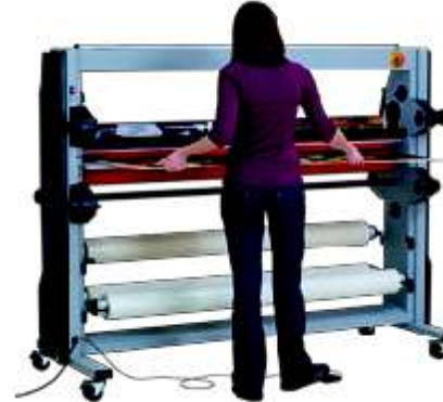
5 ejes portarrollos y un eje rebobinador suministrados con la maquina
