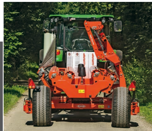
Durante el transporte por carretera, las ruedas se pueden plegar hacia dentro a fin de reducir la anchura de transporte. La función de repliegue hidráulico es opcional.
