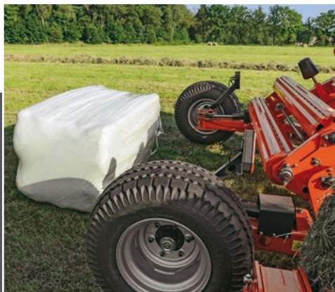
La escasa altura de la mesa permite depositar suavemente la paca para evitar el deterioro del plástico.
