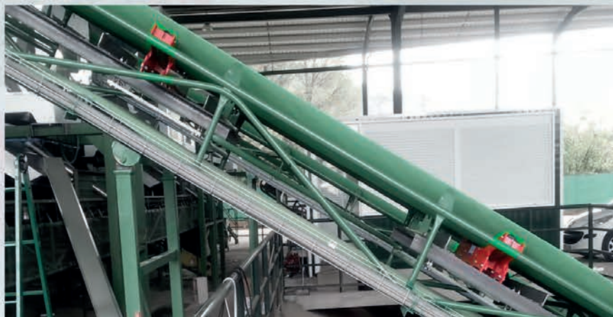
Báscula integradora Modelo Single, instalada en la cinta transportadora de una almazara
