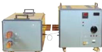
Equipo para ensayos de corriente continua
